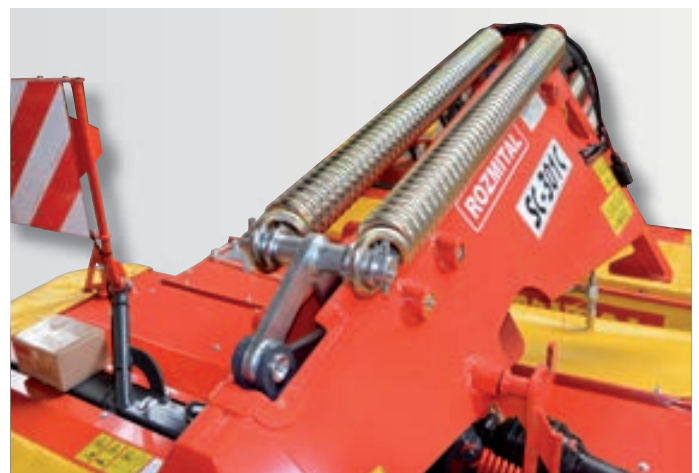
Nadlehčování lišty pomocí pružin.
