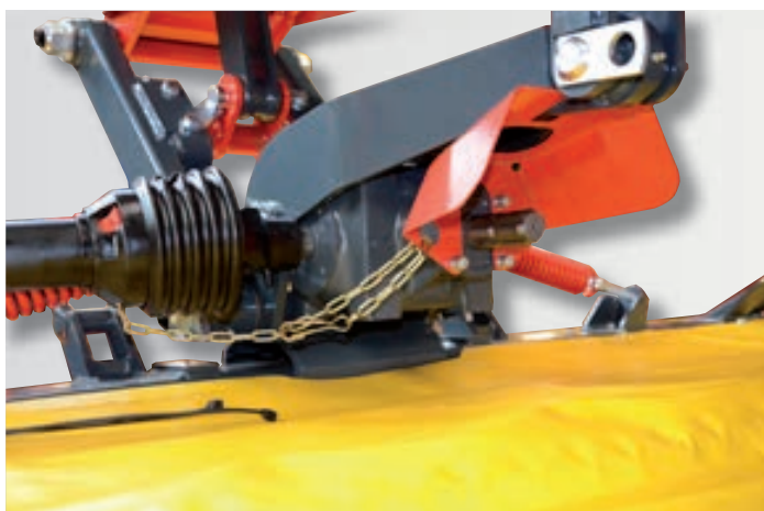
Vstupní převodovka , standardní nastavení z výroby je pro traktory s čelním náhonem s otáčením po směru hodinových ručiček, při pohledu na převodovku ve směru jízdy. Převodovku lze přestavit na náhon s otáčením proti směru hodinových ručiček.
