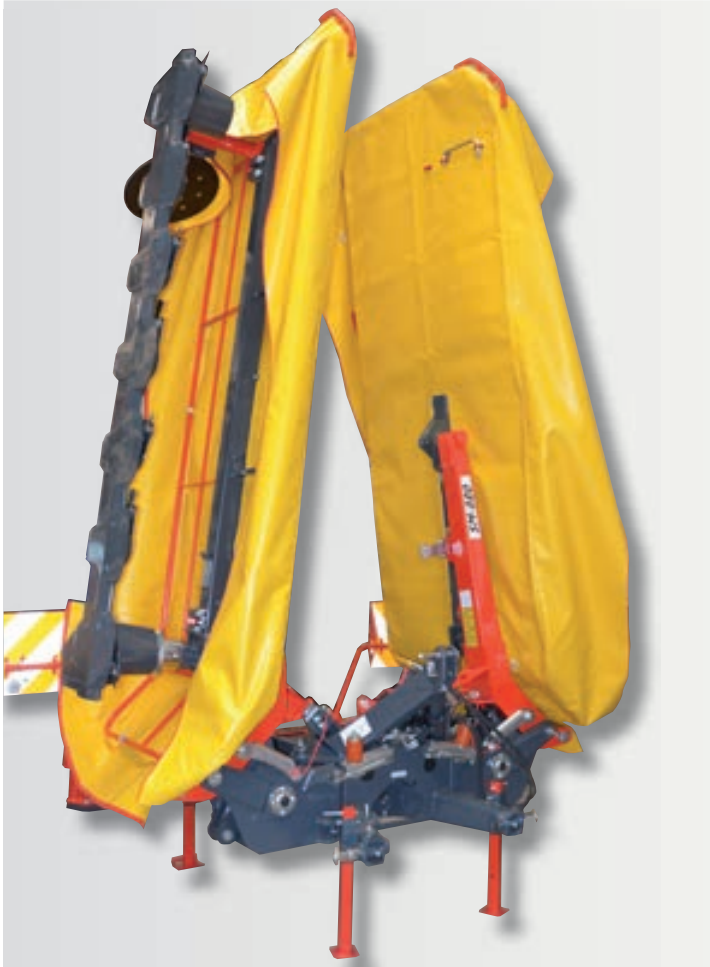
Čtyři opěrné nohy zajišťují bezpečné odstavení žací kombinace ve složeném stavu.
