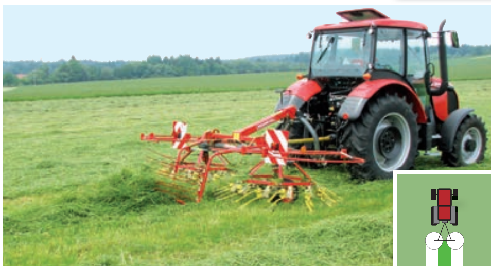
Shrnování - prutové stěny jsou v pracovní poloze
