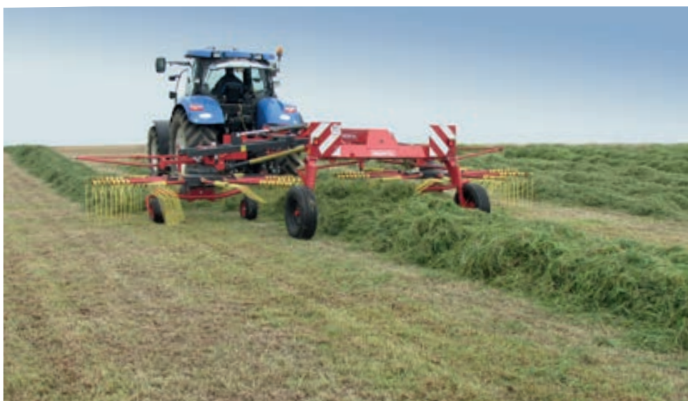
SP - 772D грабли двухроторные в среднем ряду с регулируемым рабочим захватом
