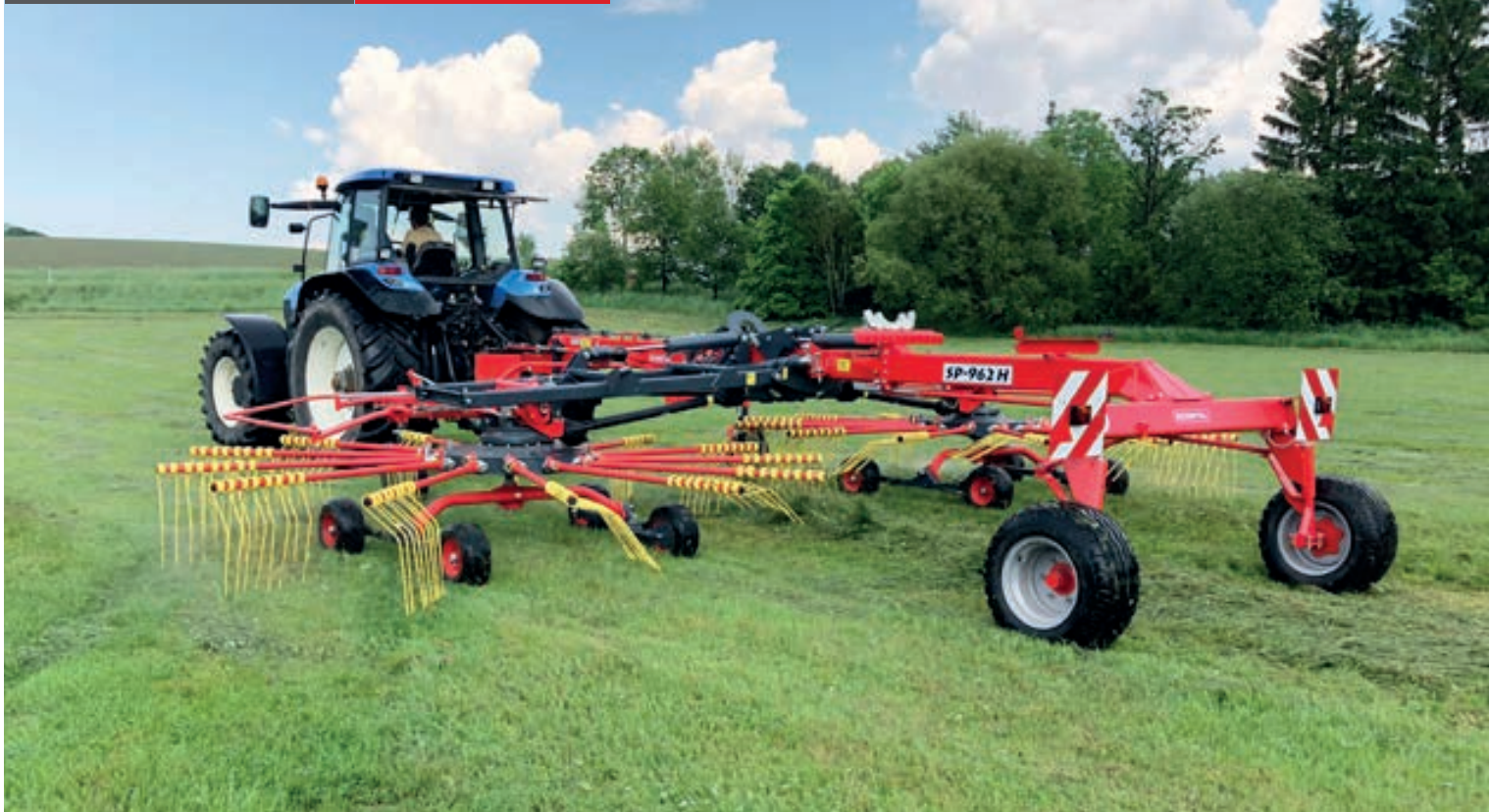
SP-962H двухроторный валкообразователь на средний ряд с гидравлически регулируемым захватом
