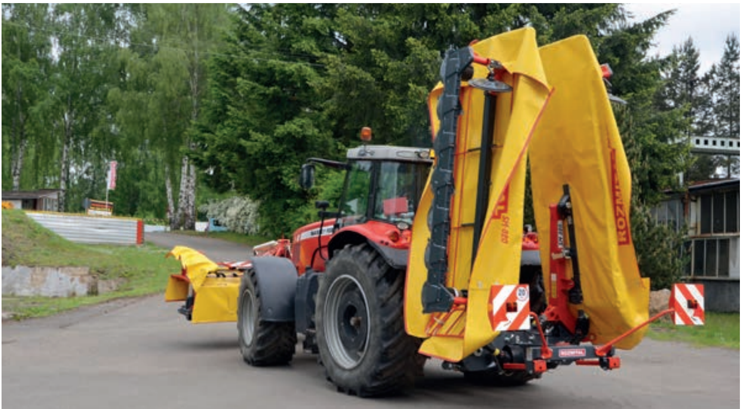
С помощью электрогидравлического распределителя можно удобно управлять обоими брусами прямо из кабины трактора.
