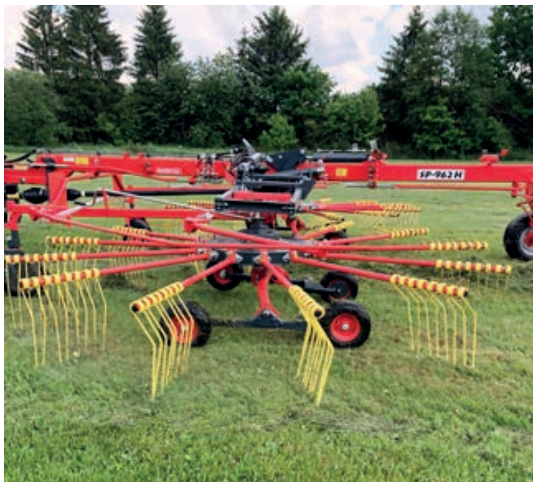
13 плечевых роторов диаметром 4,2 м, по 4 двойных пальца на плече
