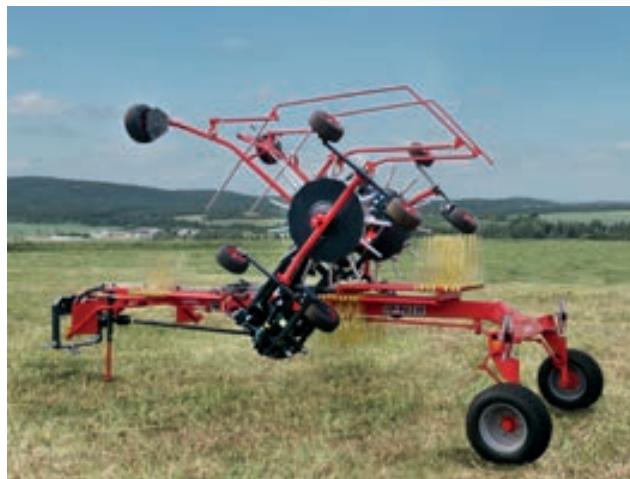
13 плечевых роторов диаметром 4,2 м, по 4 двойных пальца на плече
