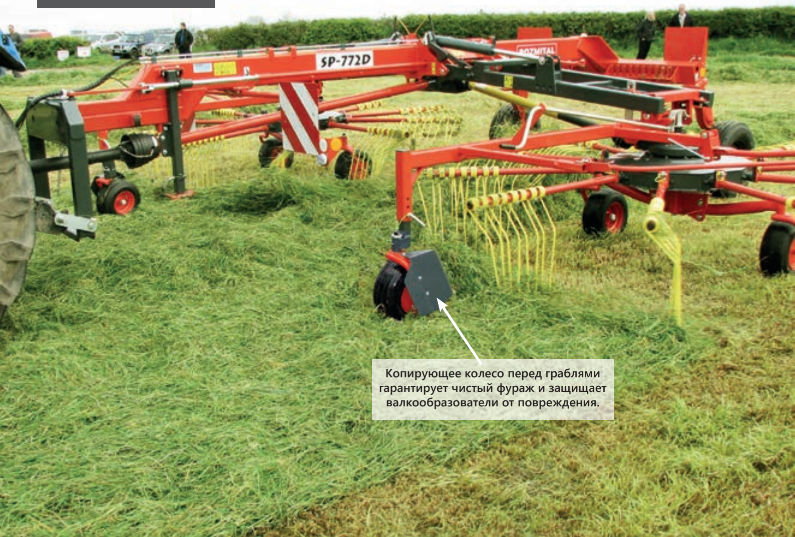
SP - 772D грабли двухроторные в среднем ряду с регулируемым рабочим захватом
