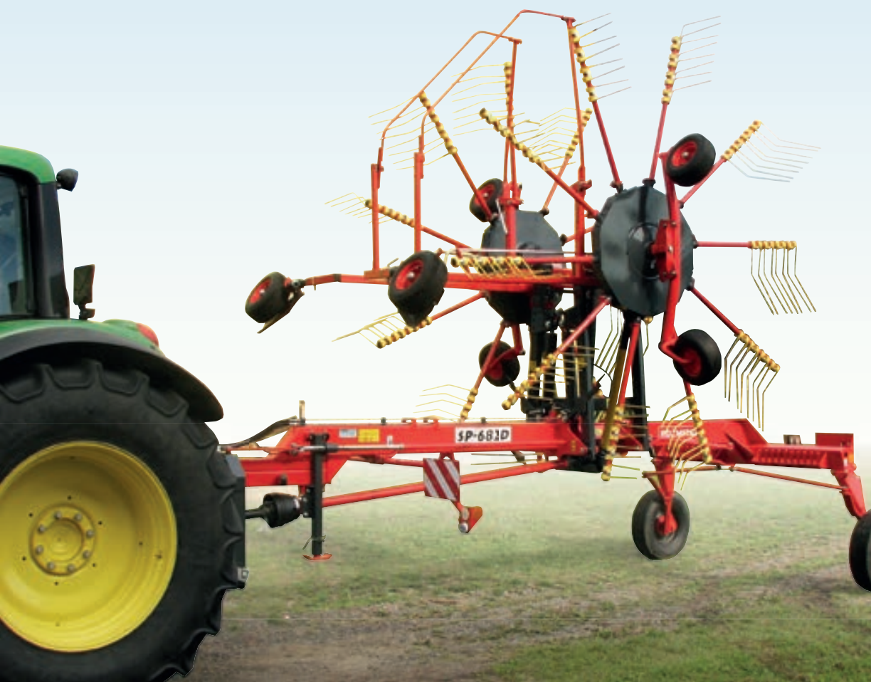
SP - 682D двухроторные валкообразователи на средний ряд с постоянной рабочей шириной
