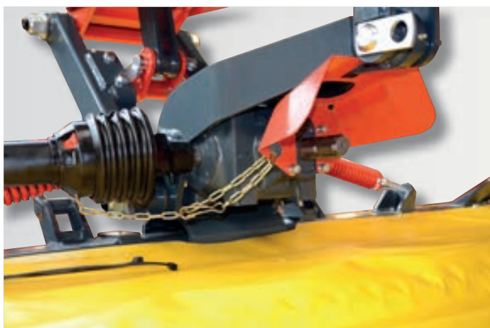
Входная коробка передач , стандартная настройка на тракторах с фронтальным приводом с направлением вращения хвостовика по часовой стрелке при обзоре коробки передач по ходу движения. Привод коробки передач можно также настроить в позицию с оборотами против часовой стрелки.
