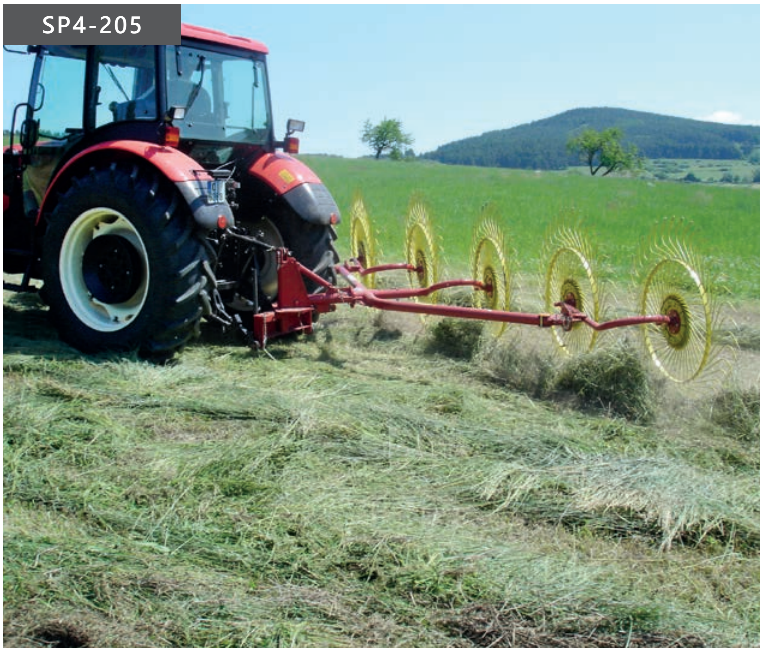
SP4-205 Универсальная ворошилка и валкообразователь в одном
