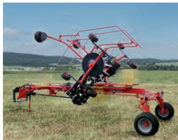
Rotoren mit 13 Armen und Durchmesser 4,2m. 4 Doppelzinken am Arme
