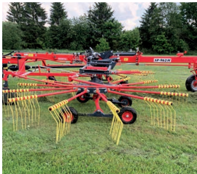
Rotoren mit 13 Armen und Durchmesser 4,2m. 4 Doppelzinken am Arme
