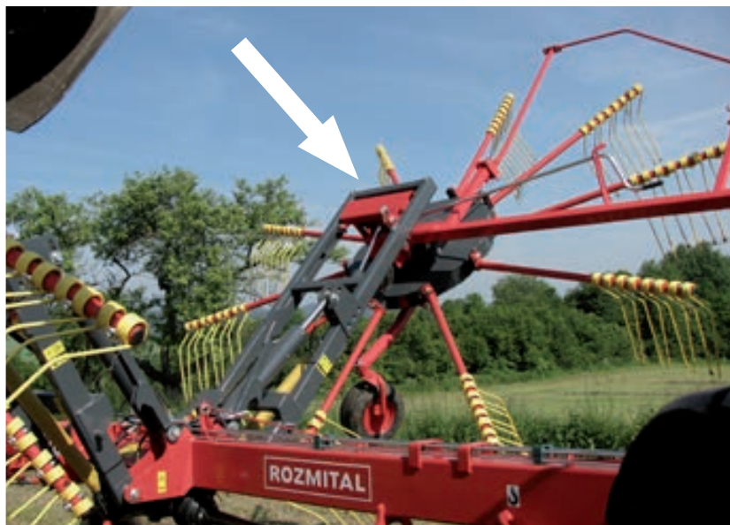
Automatische Rückkehr der Rotoren in die Transportstellung beim Einklappen der Arme
