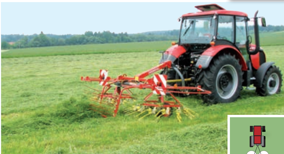
Schwadenziehen - die Rechenwände befinden sich in der Arbeitsposition
