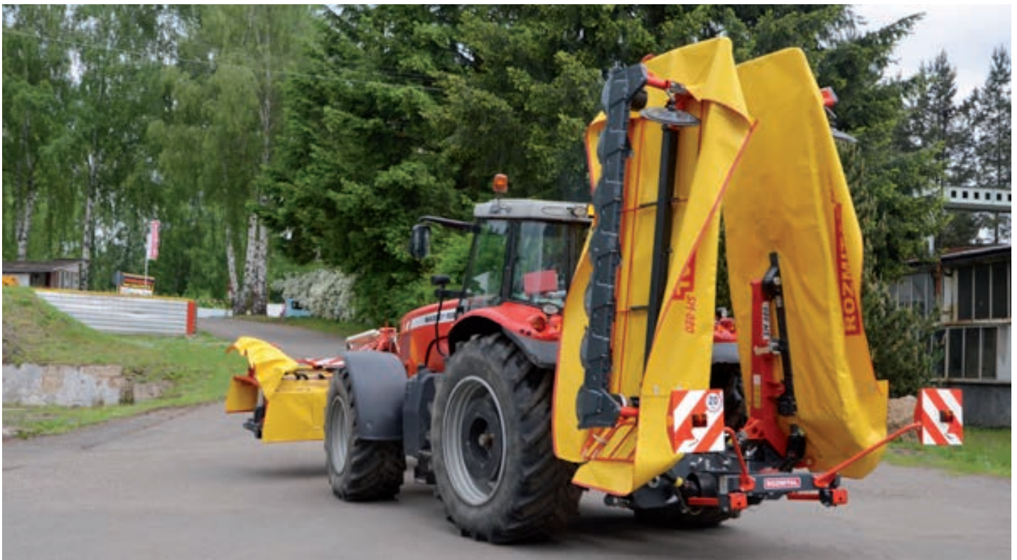
Über die elektrohydraulische Schaltanlage lassen sich die beiden Mähbalken einzeln von der Traktorkabine aus steuern.
