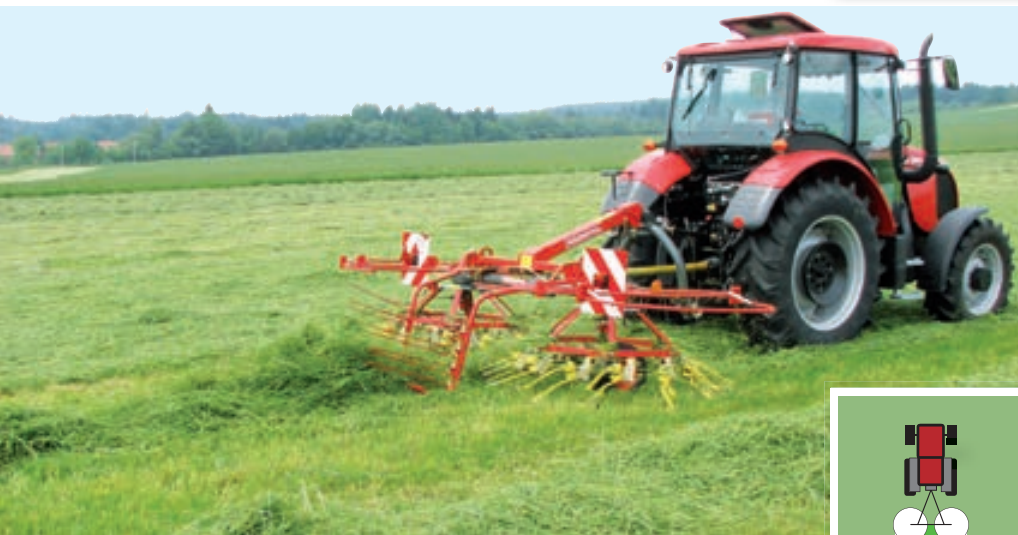
Układanie pokosu - pręty w pozycji roboczej
