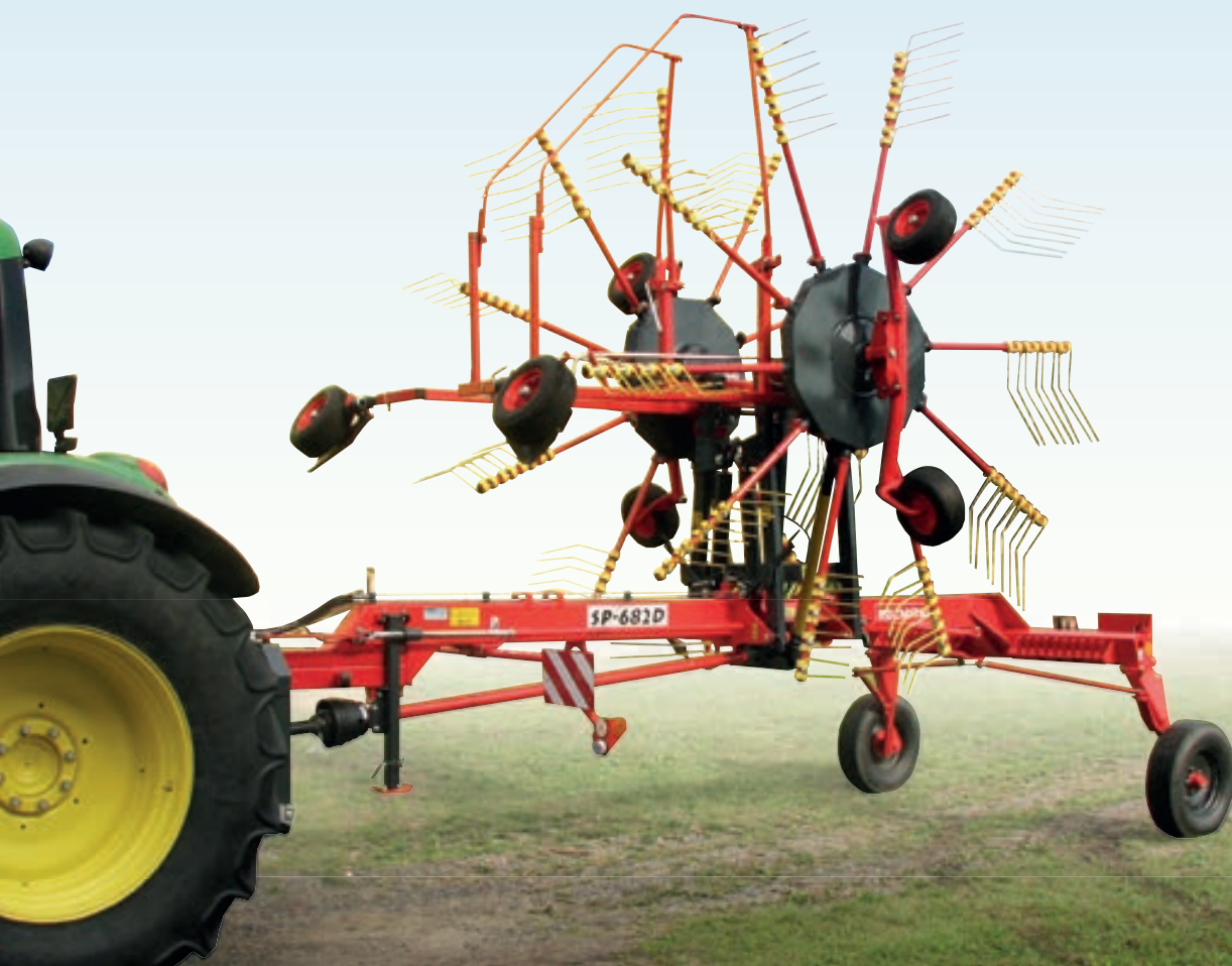
SP - 682D zgrabiarka dwuwirnikowa, centralna o stałej szerokości roboczej.
