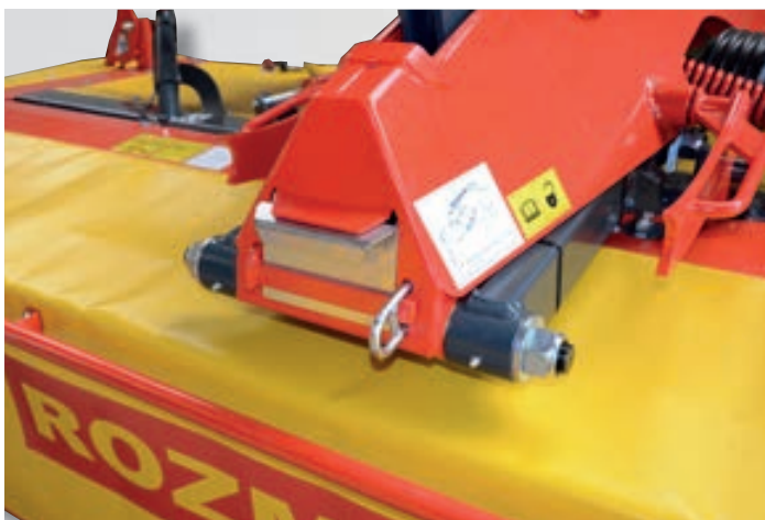
Dźwignia do szybkiego mocowania noży i przestrzeń magazynowa dla noży zastępczych.
