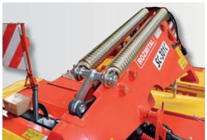
Podnoszenie listwy za pomocą sprężyn.
