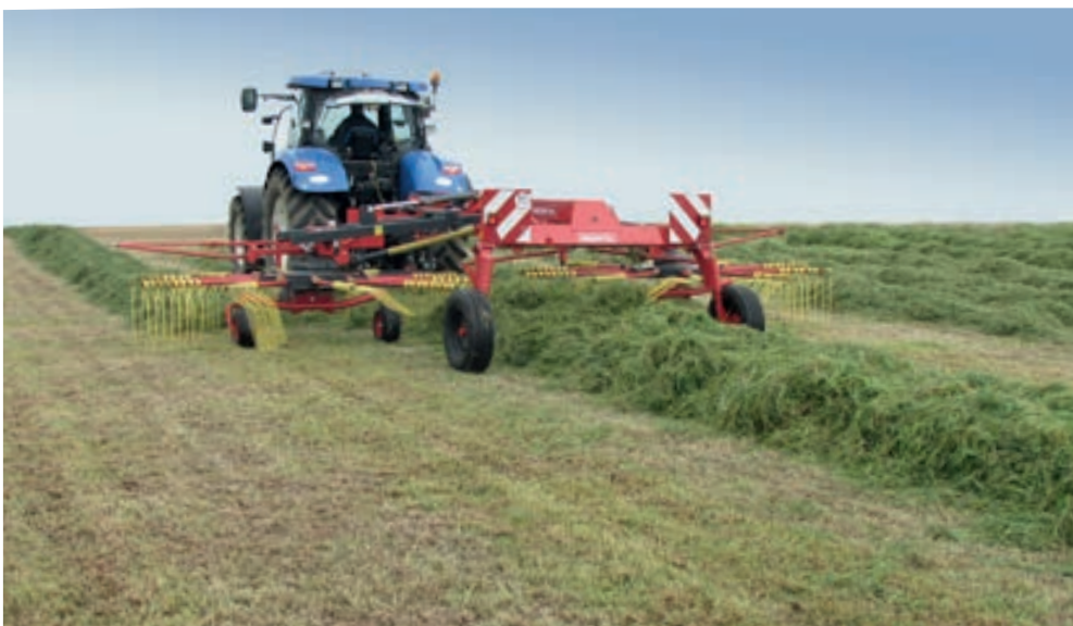
SP - 772D zgrabiarzka dwuwirnikowa centralna ze skokowo regulowaną szerokością roboczą
