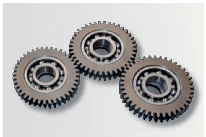
Koła zębate listwy wykute są ze stali szlachetnej, boki zębów są szlifowane. Szerokość zębów wynosi 22 mm u wszystkich kosiarek Rożmital.
