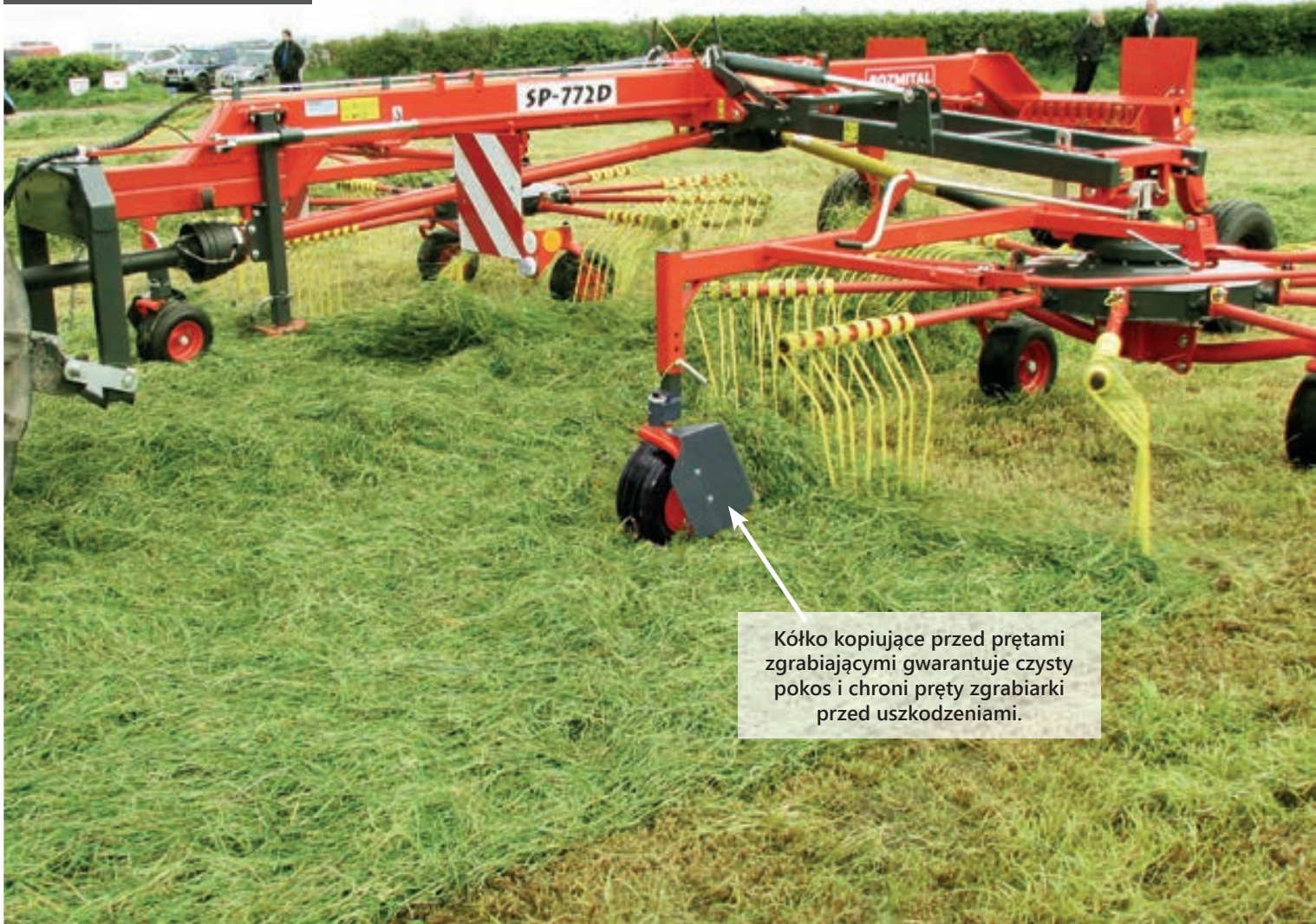
SP - 772D zgrabiarzka dwuwirnikowa centralna ze skokowo regulowaną szerokością roboczą
