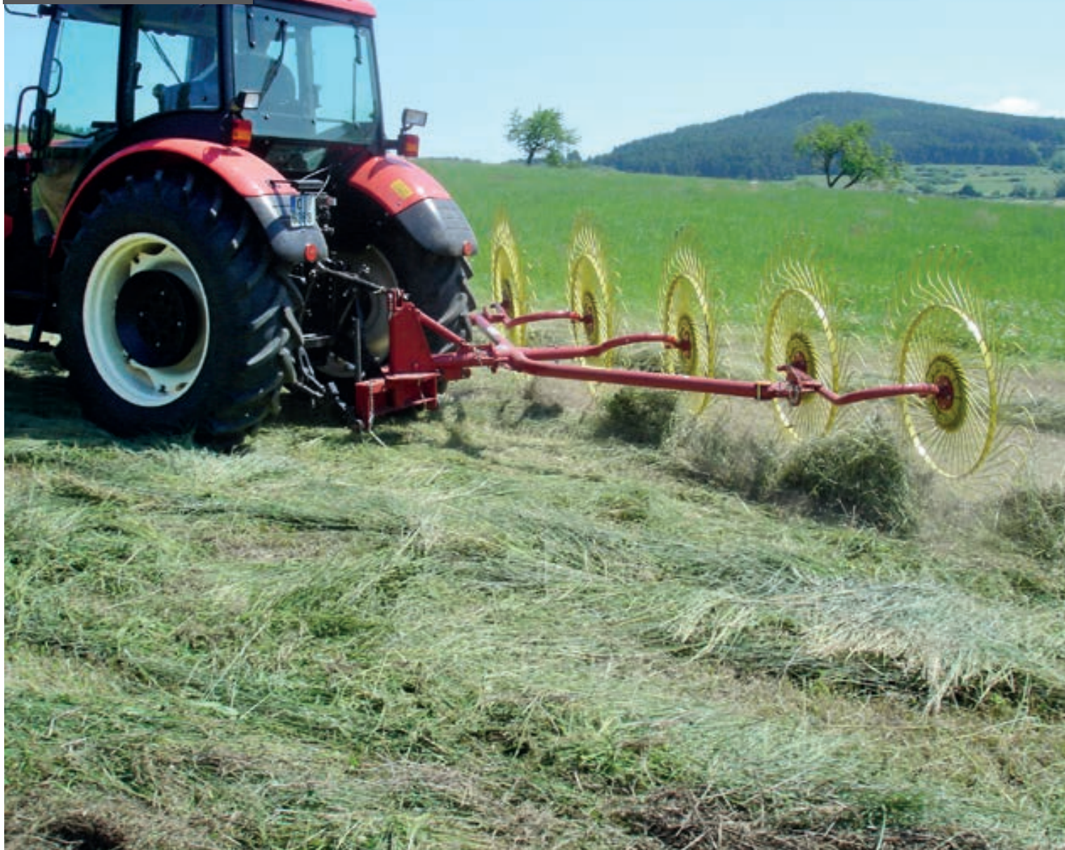
SP4-205 Uniwersalny przetrzęsacz i zgrabiarka w jednym
